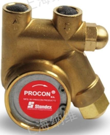
上海纳维环保设备:美国PROCON公司建立于1948年，有六十多年的水泵生产经验。PROCON高压旋转叶片泵是世界名优产品，属容积泵，属容积泵，流量可从40立升/小时至2000立升/小时范围内选择，材质由黄铜或不锈钢各自组成不同系列，单级旋转叶片可达扬程35至170米水柱，适用于输送各类清洁、低润滑性能的液体。叶片与泵体无金属接触，不仅经久耐用，而且扭距小，节省能源。该泵具有压头高、噪音低、震动小、无脉冲、可自吸、自润滑、流量恒定、使用数年不用维修等特性。已被用就于饮料、纯水、化工行业，及清洗和水切割机械等高压应用，尤其是在国际市场上畅销的碳酸饮料机和反渗透纯水机设备上，均采用该品牌系列泵为其配套设备。上海纳维环保设备:上海纳维环保设备有限公司经销批发的泵阀、配件畅销消费者市场，在消费者当中享有较高的地位，公司与多家零售商和代理商建立了长期稳定的合作关系。上海纳维环保设备有限公司经销的泵阀、配件品种齐全、价格合理。上海纳维环保设备有限公司实力雄厚，重信用、守合同、产品质量有保障，以多品种经营特色和薄利多销的原则，赢得了广大客户的信任。
