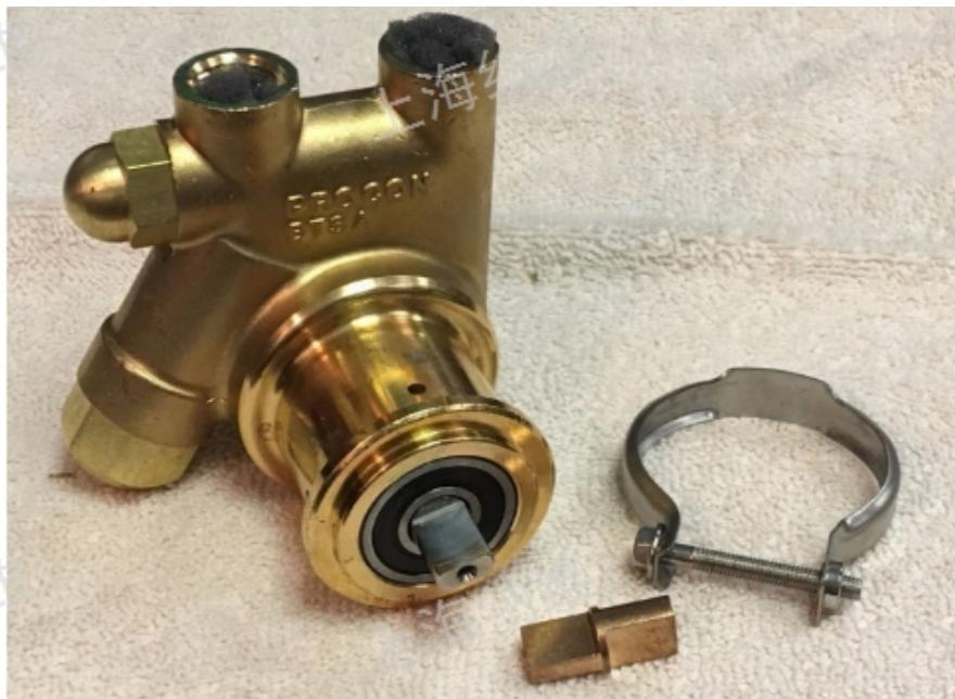
美国PROCONPUMP是世界名优产品，属容积泵，流量可从40立升/小时至2000立升/小时内选择不同型号，材质由黄铜或不锈钢各自组成不同系列，单级旋转叶片泵可达扬程140至170米水柱，适用于输送各类清洁、低润滑性能的液体。叶片与泵体无金属接触，不仅经久耐用，而且扭距小，节省能源。该泵具有压头高、噪音小、震动小、无脉冲、可自吸、自润滑、流量恒定、使用数年不用维修等特性。PROCON103系列不锈钢PUMP参数：不锈钢泵体，无内置滤网，内置安全阀，流量15-140加仑/小时，螺栓固定，应用于：碳酸水等软饮料机，高压咖啡机，啤酒
